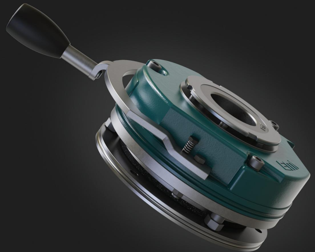
Les freins de la série YBF, qui ont une structure compacte, sont des systèmes faciles à installer qui sont activés lors de pannes de courant contrôlées ou non contrôlées. Il est utilisé pour maintenir les arbres mobiles dans la position souhaitée et arrêter l'inertie de rotation pour un fonctionnement sûr.
